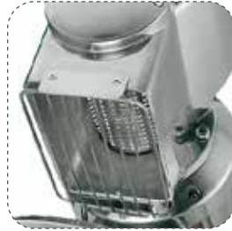
Muhafazalı Rende / Paslanmaz çelik silindir
